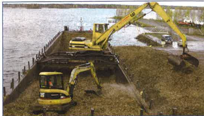
Toisessa kuljetuskokeilussa käytettiin proomussa mukana kulkevaa kaivinkonetta ja tiivistämiseen Bobcattia. Lastauksen hoiti Yösti ja Aleksi Ryynänen. (Karttunen)
